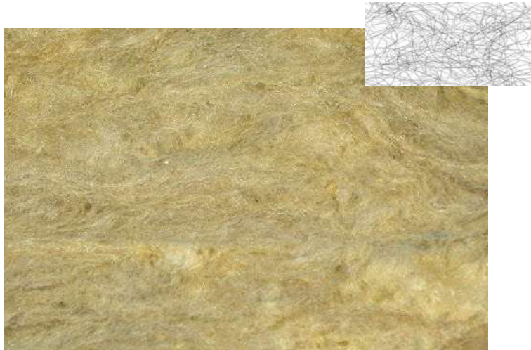
Laine de roche = Fibres courtes enchevêtrées
